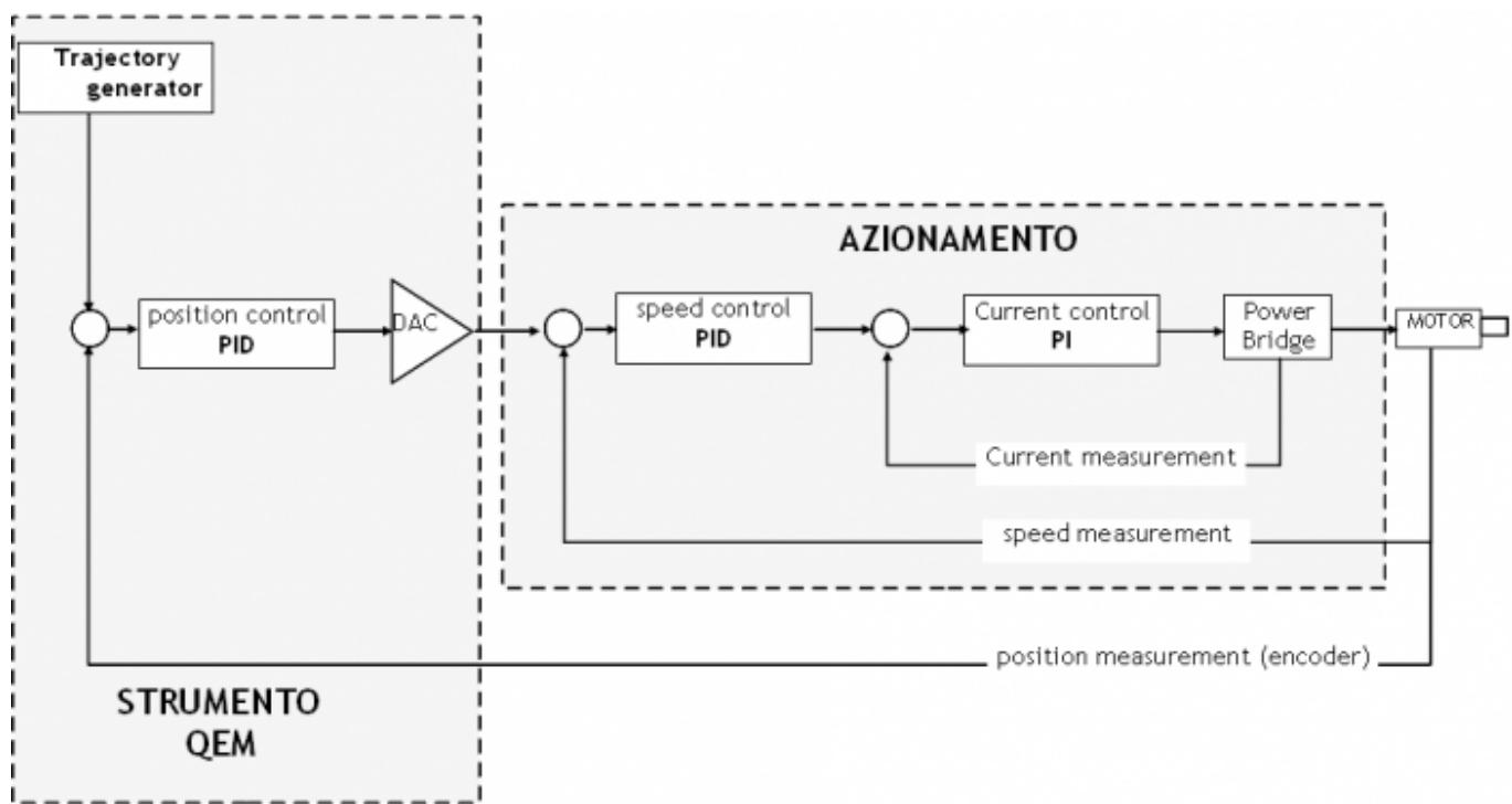
Lo strumento QEM implementa il generatore della traiettoria e il loop di posizione.
