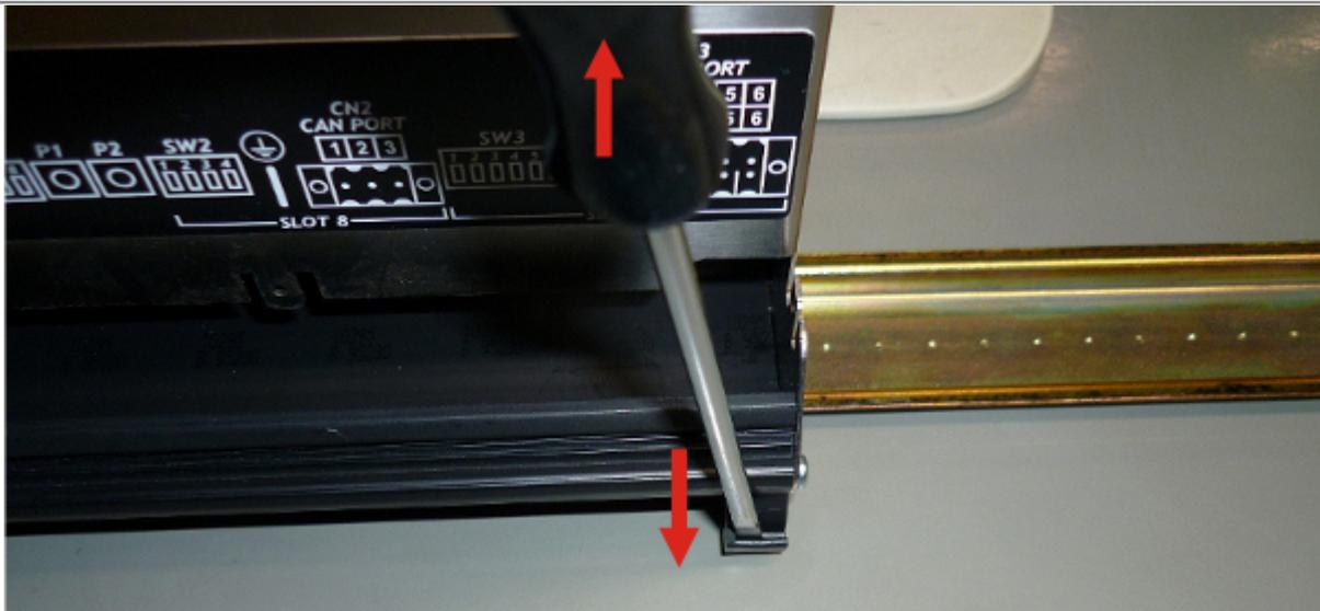
Mantenendo la spinta verso l'alto sullo strumento, fare leva con un cacciavite sulla linguetta del gancio dx, come indicato, fino al completo sblocco dello strumento
