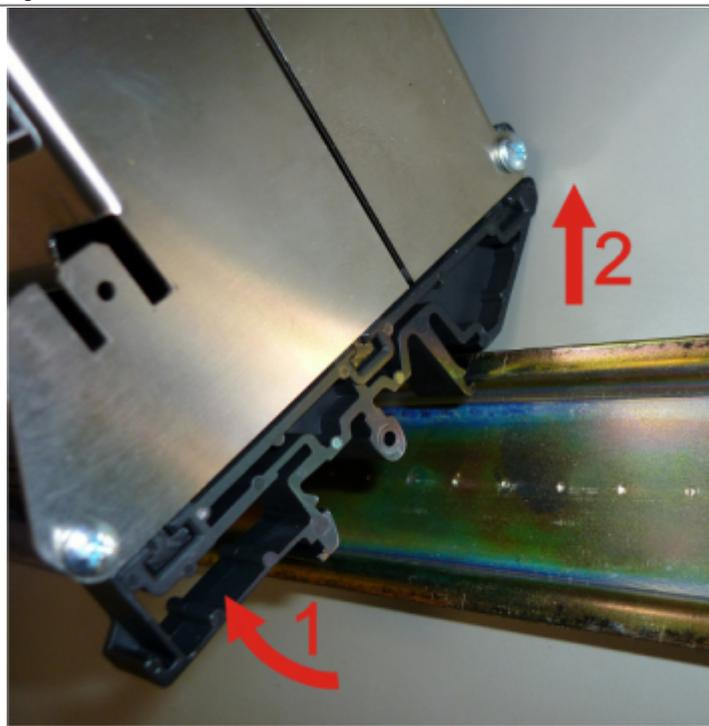
Rimuovere lo strumento dalla guida DIN (1), alzandolo in direzione verticale (2)
