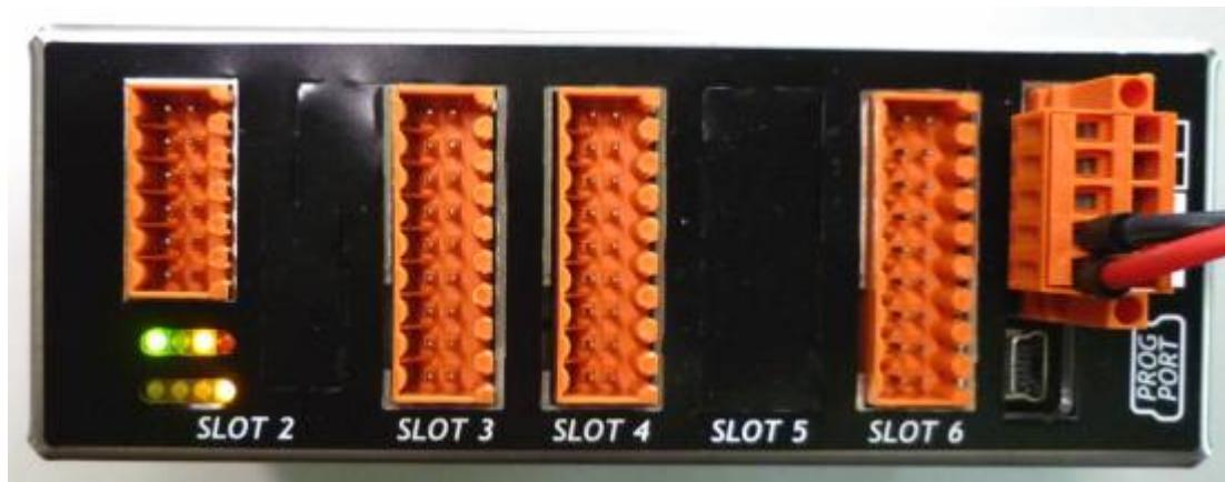
**12.** A operazione conclusa i led **L4** e **STOP** si spengono e si accendono i leds **POW** e **RUN**.
