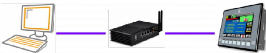
Il QBridge è predisposto per collegarsi e scambiare dati col QMove. Questi dati vengono resi disponibili tramite un server, e permettono ai PC client la realizzazione di una serie di servizi, tra cui: monitoraggio dati macchina, invio programmi di lavoro, recupero file di log. Il Data Exchange è un software per il PC client che fornisce all'utente un'interfaccia grafica per usufruire di questi servizi. Ecco alcune schermate di esempio del Data Exchange:
