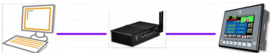
Il QBridge è predisposto per collegarsi e scambiare dati col QMove. Questi dati vengono resi disponibili tramite un server, e permettono ai PC client la realizzazione di una serie di servizi, tra cui: monitoraggio dati macchina, invio programmi di lavoro, recupero file di log. Il Data Exchange è un software per il PC client che fornisce all'utente un'interfaccia grafica per usufruire di questi servizi. Ecco alcune schermate di esempio del Data Exchange:
