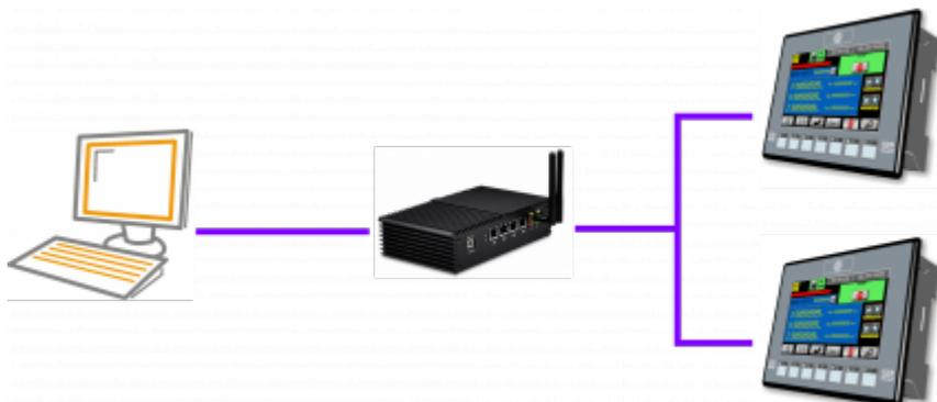
La procedura per configurare il Data Exchange è la stessa. Dobbiamo solo avere cura di assegnare due indirizzi diversi ai due QMover (per esempio 10.20.2.2 e 10.20.2.3) e aggiungere due controller con nomi diversi nel QBridge (per esempio Macchina1 e Macchina2). Ovviamente le due istanze di Data Exchange andranno configurate per accedere ciascuna alla propria macchina (nella pagina di Impostazioni inseriremo *Nome macchina* diversi, per esempio Macchina1 in una istanza, Macchina2 nell'altra).
