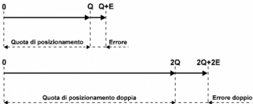
Fig. 3 - Errori di misura causati dalle oscillazioni dei materiali misurati
