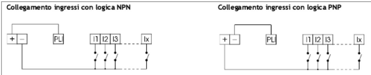
**COLLEGAMENTO INGRESSI DIGITALI ALIMENTAZIONE: TENSIONE CONTINUA (12÷24 VDC) ESTERNA ALLO STRUMENTO**
