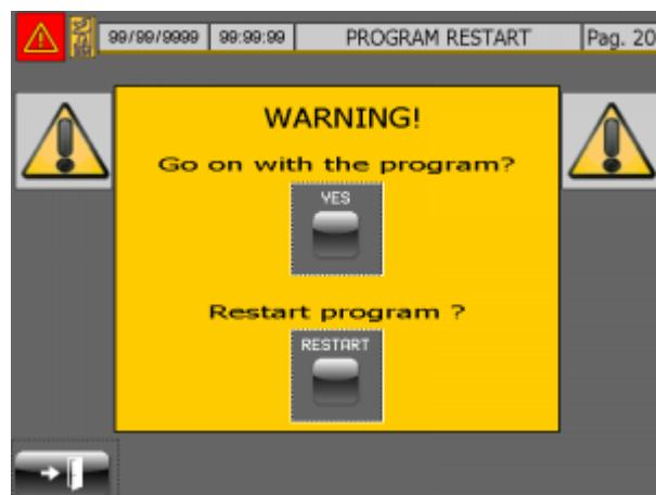
Am natürlichen Ende des automatischen Zyklus wird die Klinge auf die oberste Position gebracht und das Programm wird automatisch zurückgesetzt.
