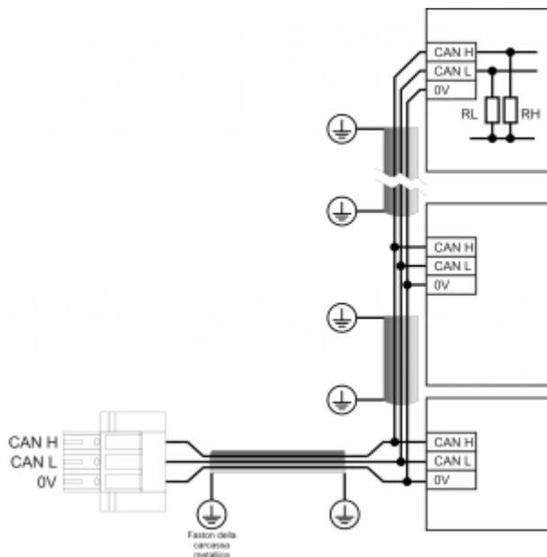
Esempio di collegamento CAN BUS.
