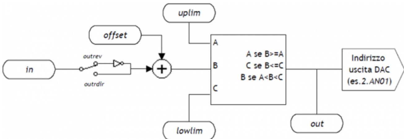
Il device DAC, poiché lavora con una risoluzione di 16 bit, accetta in ingresso valori compresi fra -32768 e 32767: il valore di tensione dell'uscita è proporzionale al valore introdotto dall'utilizzatore. Il device ha comportamento simmetrico rispetto il valore zero di tensione analogica a meno di un eventuale valore di offset introdotto. I valori di tensione analogica minimo e massimo possono essere limitati con i parametri lowlim ed uplim, sempre restando entro il limite  $\pm 10$  V:
