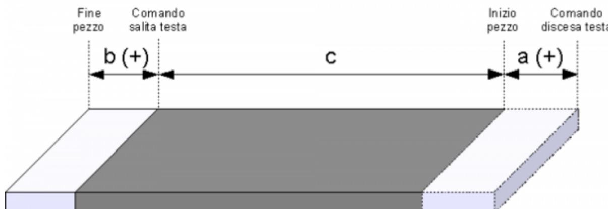
Nel caso in cui vengano impostati valori negativi il pezzo verrà lavorato come da disegno sottoriportato; la quota **a** è pari al valore impostato nel parametro `downlag1,2,3`, mentre la quota **b** è pari al valore impostato nel parametro `riseadv1,2,3`.
