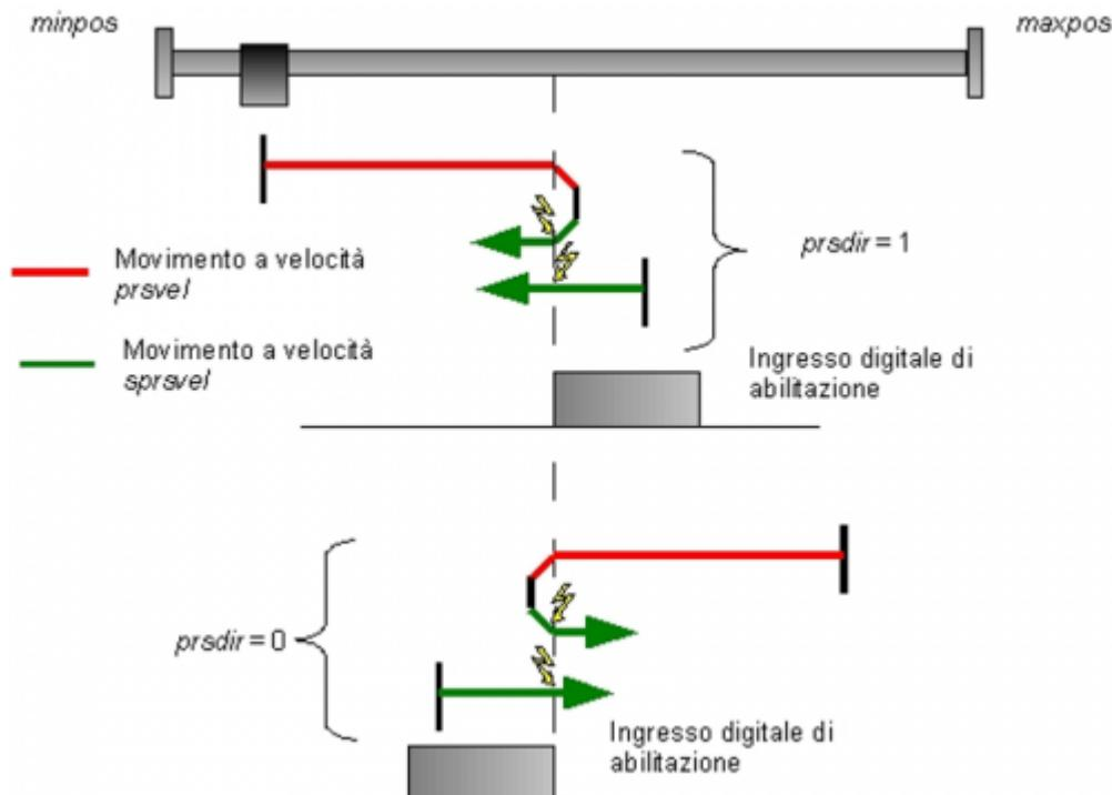
Questa modalità prevede la movimentazione dell'asse e l'utilizzo del solo ingresso digitale di abilitazione. Alla disattivazione dell'ingresso digitale la posizione dell'asse assume il valore presente nel parametro *prspos*. Successivamente si disattiva lo stato *st\_prson* e si attiva lo stato *st\_prsok* per segnalare la conclusione della ricerca. Questo stato rimane attivo fino all'avviamento di una nuova procedura di ricerca.
