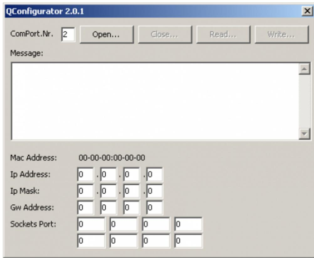
Inserire nel campo „**Com Port Nr.**“ il valore della porta seriale a cui è connesso lo strumento QEM. Se ad esempio si utilizza la porta COM2, inserire il valore '2' come in figura.
