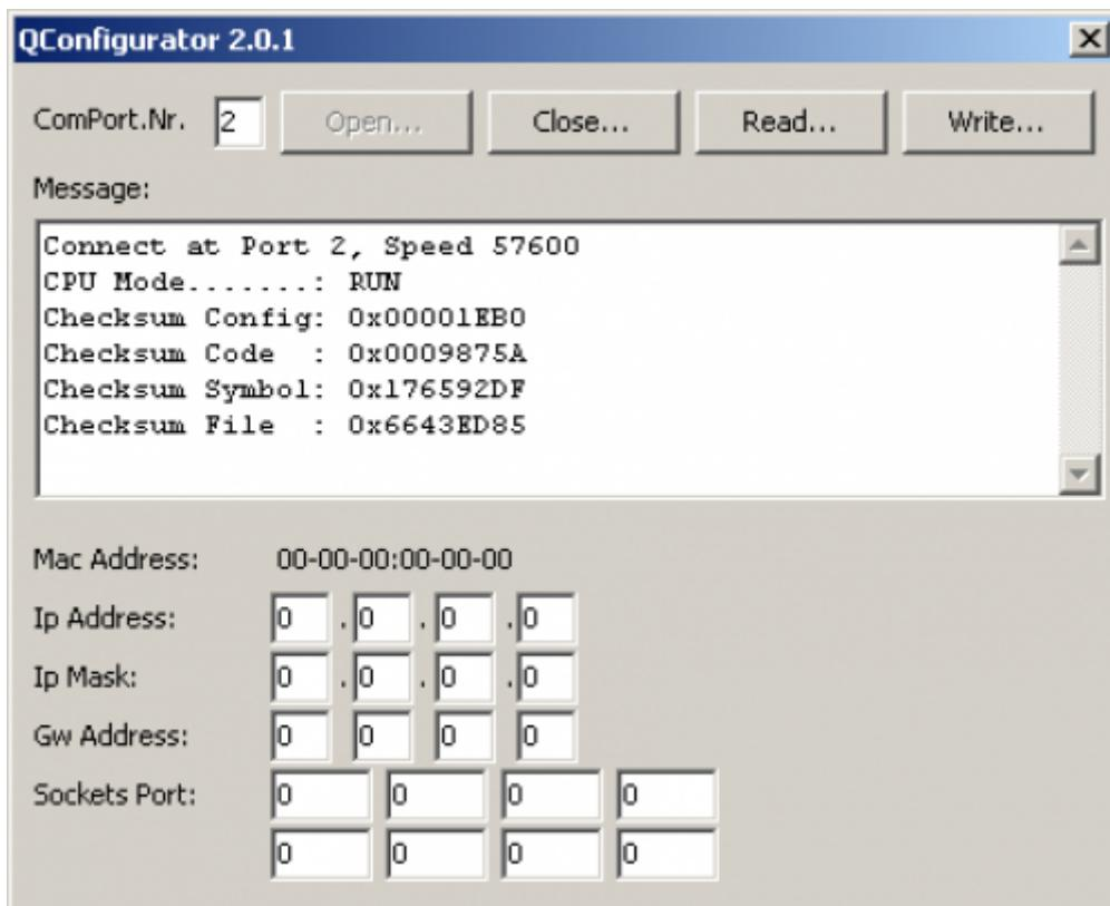
A questo punto è possibile richiedere i valori delle impostazioni dell'interfaccia ethernet dello strumento premendo il pulsante „**Read...**“.
