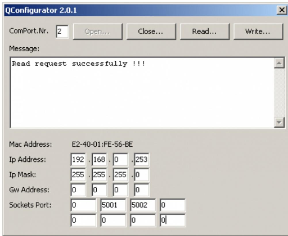
Ogni strumento permette la configurazione dell'interfaccia ethernet permettendo l'impostazione dei seguenti parametri:
