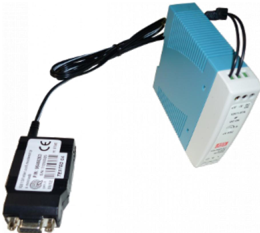
Permette di collegare i dispositivi QEM della serie Qmove+ ad un PC o ad un modem, dotati di porta seriale RS232.
