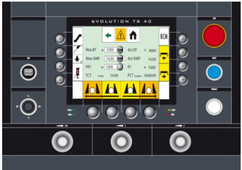
Il PMQ4C è un controllore integrato della gamma [microQmove](#). Si contraddistingue per il display LCD da 8 pollici, il touch-screen, 12 tasti funzione personalizzabili ed un elevato numero di I/O.
