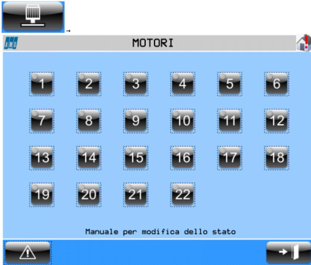
In questa pagina è possibile forzare le uscite di attivazione dei motori delle teste, a condizione di essere in stato manuale. Per fare questo basta premere sul tasto con il numero della testa che si vuole attivare e verrà visualizzato sullo stesso un led che ne indica lo stato.
