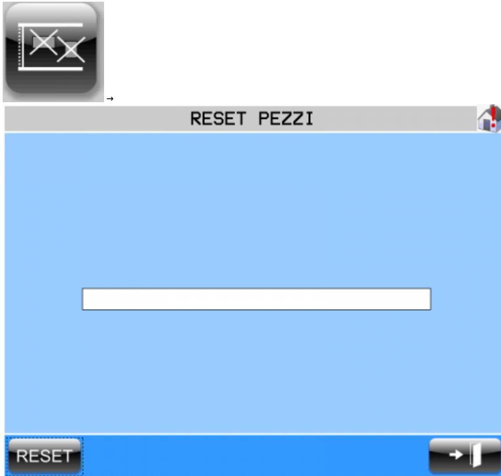
La procedura di cancellazione pezzi consente di eliminare dalla memoria dello strumento i pezzi che sono stati rilevati dalla barra di sensori e sono al momento sul nastro. Quindi dopo questa procedura le teste non scenderanno più per andare a levigare i pezzi.
