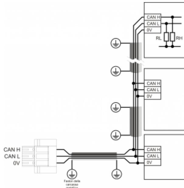
Esempio di collegamento CAN BUS.
