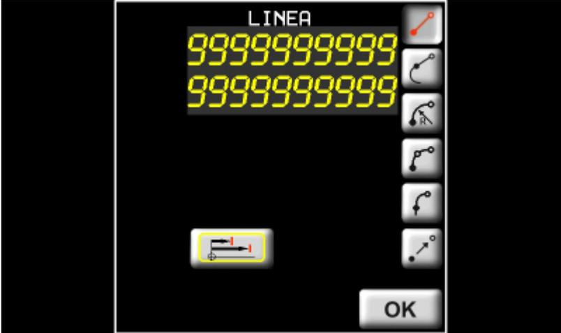
Per disegnare una linea, è necessario inserire le quote delle ascisse e delle ordinate (incrementali o assolute) del punto finale.
