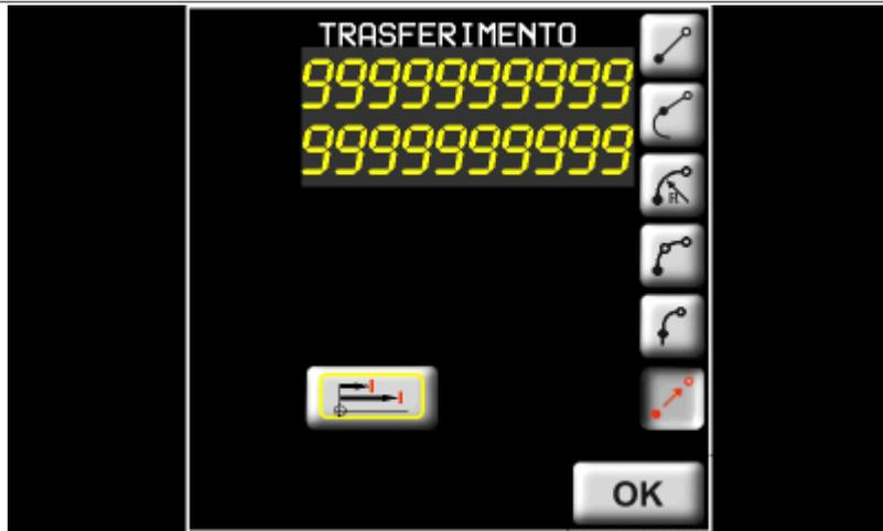
Lo strumento "trasferimento" permette di disegnare tratti di profilo che non verranno lavorati, ma solamente utilizzati per effettuare spostamenti rapidi della lama/utensile.
