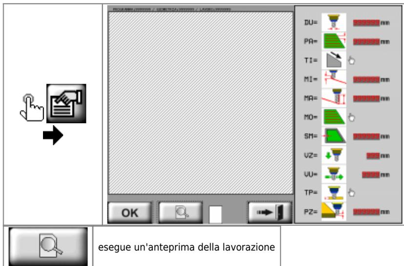
L'area interna di una geometria chiusa viene fresata per realizzare una tasca. Il fondo della tasca può essere inclinato secondo una direzione impostata.
