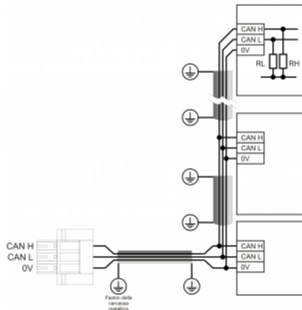
Esempio di collegamento CAN BUS.
