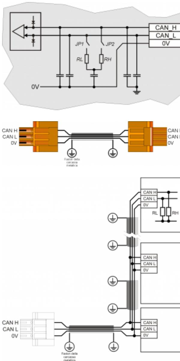
Esempio di collegamento CAN BUS.
