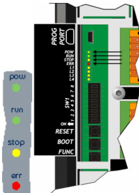
I led **"L1, L2, L3 e L4"** sono detti "Led utente" e sono presenti solo sulla parte posteriore dello strumento:
