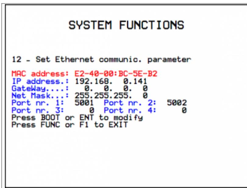
Per modificare un parametro, premere il tasto ENTER ed introdurre il nuovo valore. Alla pressione del tasto ENTER viene posto in modifica il campo successivo. Alla conferma dell'ultimo campo i dati vengono salvati e durante l'operazione viene visualizzato il messaggio "saving data..."
