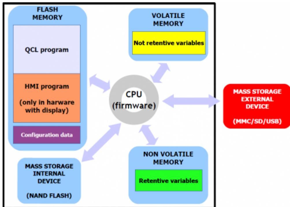
Come si può notare, all'interno di un hardware QMOVE, vi sono più dispositivi di memorizzazione di tecnologia anche diversa (ad esempio la memoria dati non volatile potrebbe essere una ram tamponata piuttosto che una eeprom, piuttosto che una ram magneto-resistiva, ...) che sono stati divisi nelle seguenti categorie:
