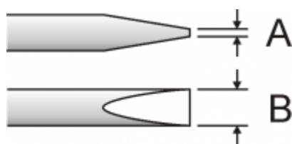
Cacciavite a lama piatta secondo DIN 5264. Coppia di serraggio: 0,4 + 0,5 Nm.
