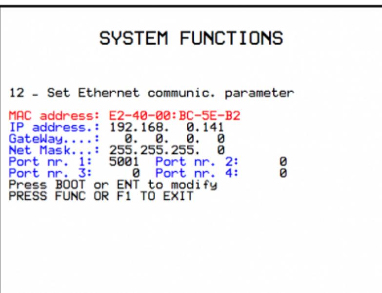
Vediamo in dettaglio: La porta impostata in "Port nr.1:" rappresenta un canale di comunicazione equivalente alla PROG PORT. La porta impostata in "Port nr.2:" rappresenta un canale equivalente alla USER PORT. Le porte 3 e 4 non sono attualmente utilizzate.
