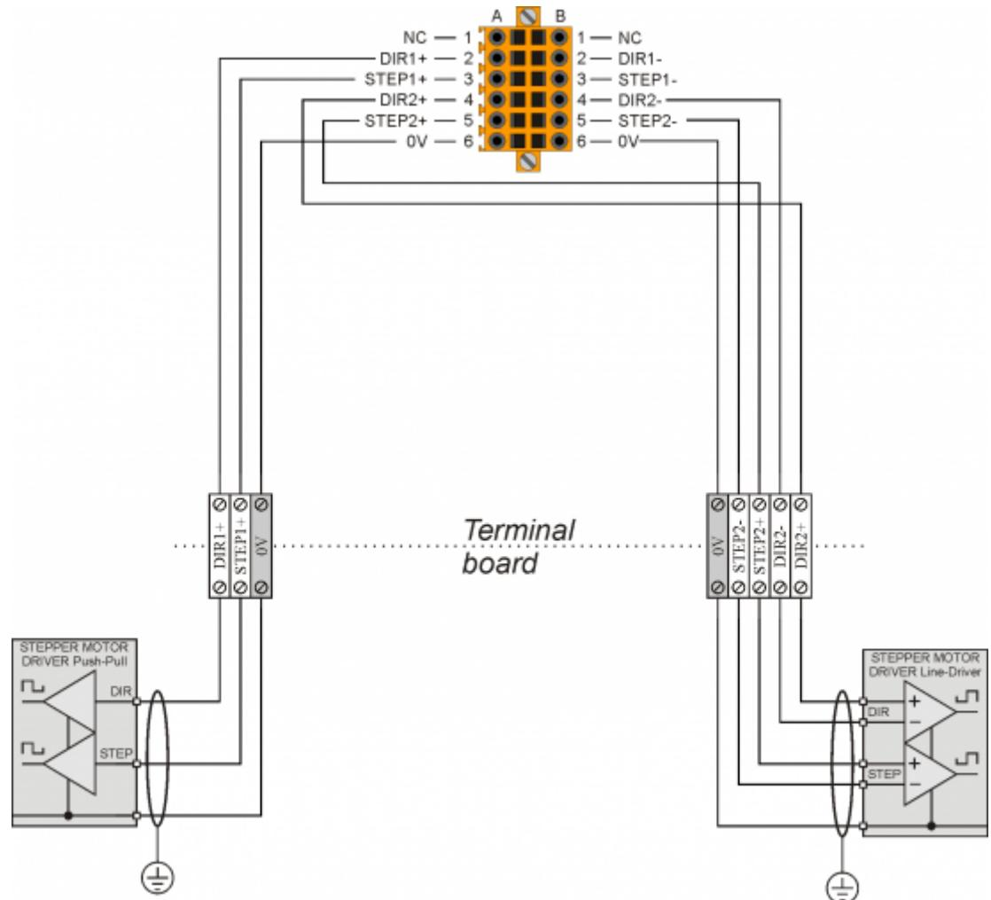
Esempio con Uscita 1 Push-Pull e uscita 2 Line-Driver
