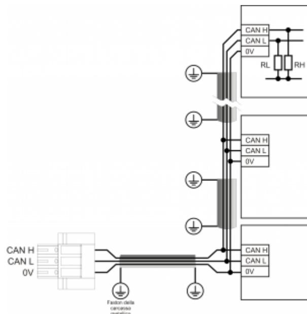
Esempio di collegamento CAN BUS.
