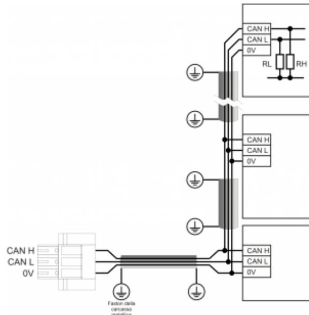
Esempio di collegamento CAN BUS.
