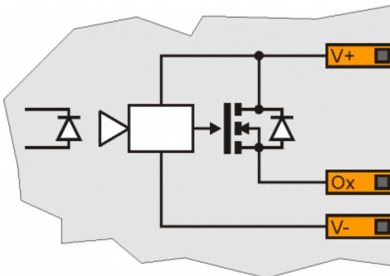
**4.14 Uscite per motore stepper**
