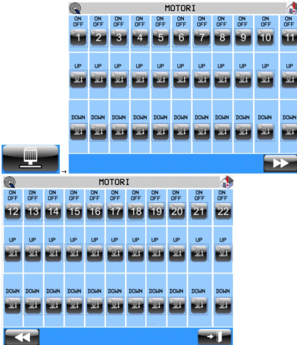
In questa pagina è possibile forzare le uscite di attivazione dei motori, la salita e la discesa delle teste a condizione di essere in stato manuale.
