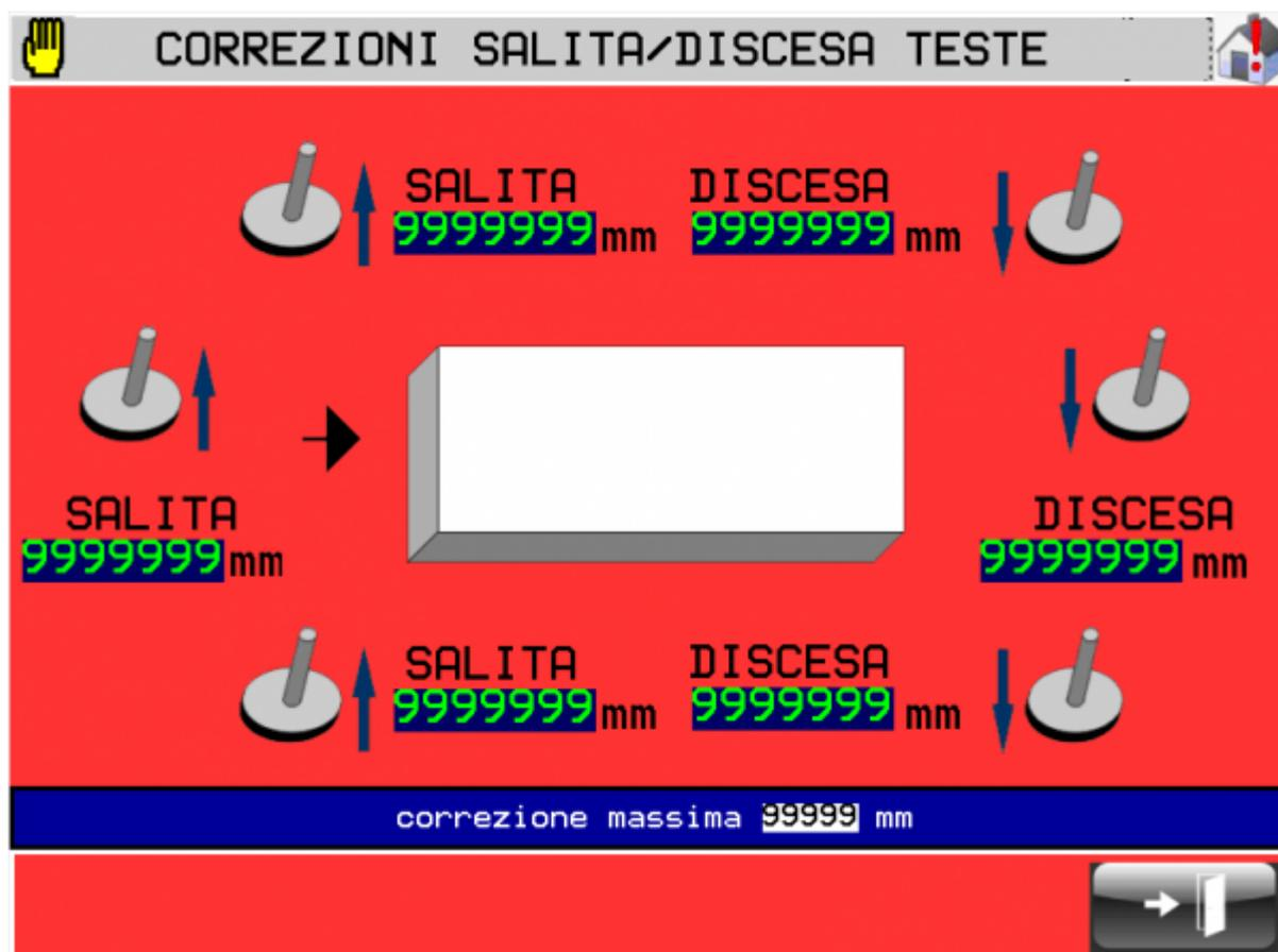
In questa pagina è possibile inserire delle correzioni **permanenti** per la salita/discesa teste. Le correzioni possono essere orizzontali o verticali, quindi riguardano tutti i bordi del materiale.
