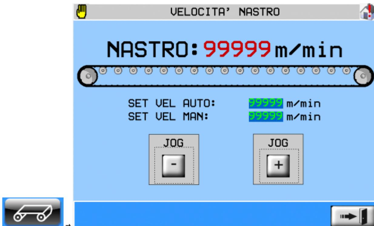
In questa pagina è possibile vedere la velocità attuale del nastro, modificare la velocità automatica e manuale. In stato manuale è inoltre possibile muovere il nastro in JOG, premendo nei pulsanti relativi per muoverlo avanti o indietro. Se il nastro viene spostato manualmente, per effettuare una partenza automatica occorre eseguire un reset pezzi.
