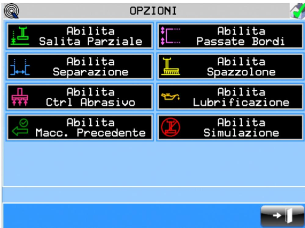
In questa pagina sono visualizzate tutte le opzioni impostabili riguardo il funzionamento della macchina. E' possibile attivare o disattivare le opzioni semplicemente toccando sul relativo riquadro.
