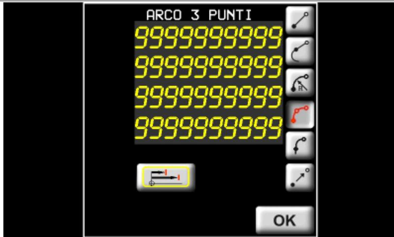
Per disegnare un arco a 3 punti, è necessario inserire sia le quote delle ascisse e delle ordinate sia del punto finale che del punto intermedio.
