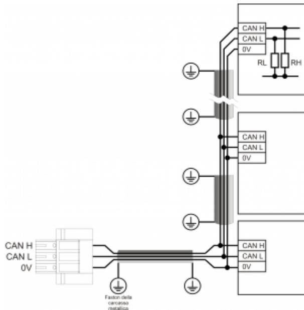
Esempio di collegamento CAN BUS.
