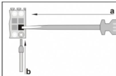
a) inserire il cacciavite senza ruotarlo
