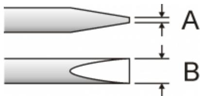
Cacciavite a lama piatta secondo DIN 5264. Coppia di serraggio: 0,4 ± 0,5 Nm.
