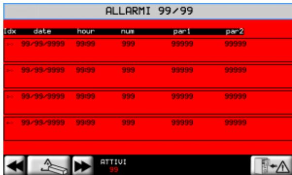
Per ogni allarme viene assegnata una data e un'ora, un indice di errore e due parametri per eventualmente specificare nel dettaglio l'anomalia visualizzata.
