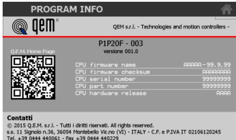
Sono elencate le info di diagnostica delle CPU, più altre informazioni utili all'identificazione dello strumento, il software installato e come contattare la casa produttrice.
