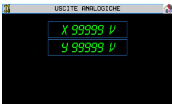
Viene visualizzato per ogni asse il valore della tensione in uscita, espressa in decimi di Volts.
