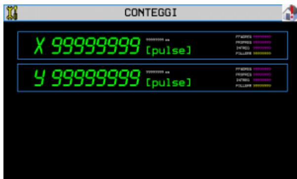
Viene visualizzato per ogni asse il conteggio in impulsi encoder.
