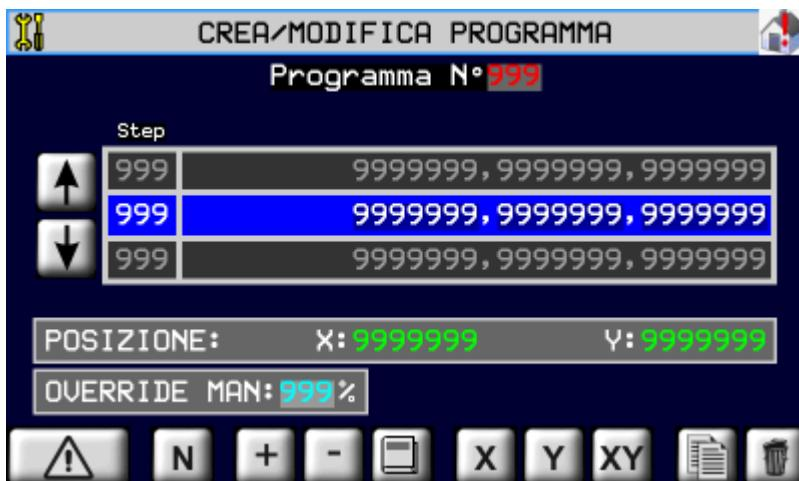
Alla pagina di programmazione è possibile avere accesso solamente quando lo stato macchina non è in automatico ON. La pagina di programmazione permette di compilare una sequenza di istruzioni e di salvarla in una determinata zona della memoria.
