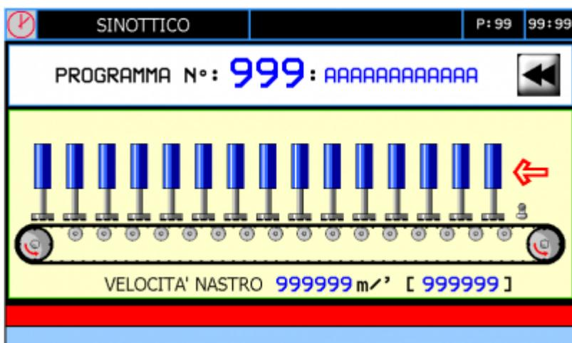
In queste pagine un sinottico mostra le teste in lavorazione, il movimento e la velocità del nastro trasportatore, lo stato del sensore di ingresso materiale ed eventualmente lo stato dei motori dei mandrini.
