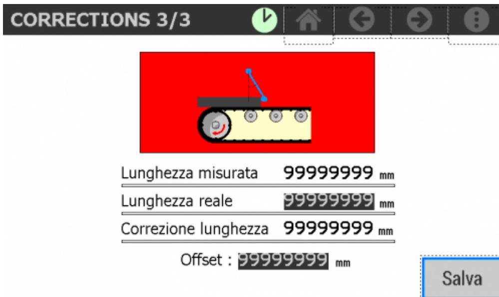
La taratura offset serve per calcolare la differenza tra il **punto di attuazione** e il **punto di disattivazione** del finecorsa presenza pezzo.
