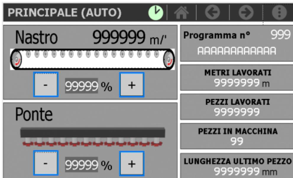
Pagina principale quando la macchina è in modalità automatico. Da questa pagina è possibile monitorare la velocità del nastro, il programma in uso, i metri lavorati, i pezzi lavorati, i pezzi in macchina e la lunghezza dell'ultimo pezzo. È possibile aumentare o diminuire la velocità del nastro e del ponte premendo direttamente nel campo e digitando il valore oppure utilizzando i pulsanti + e -. Le velocità impostabili sono in %.
