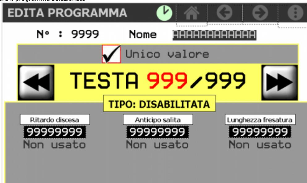
Nel programma è possibile inserire degli anticipi o ritardi per tutte le teste o quelle selezionate. Se una delle teste è usata come fresatrice è possibile inserire la lunghezza della fresatura.
