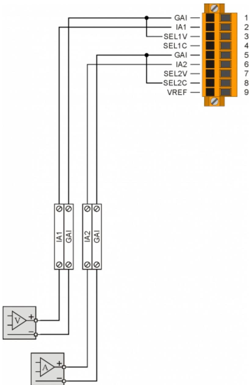
**Ingressi analogici voltmetrici e potenziometrici**
