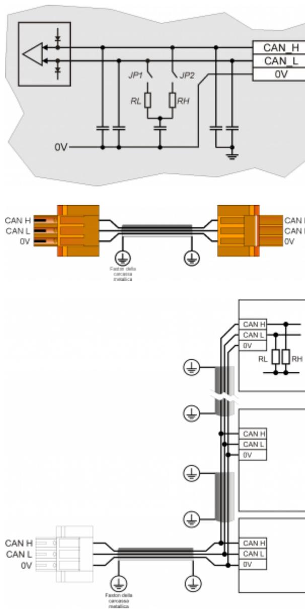
Esempio di collegamento CAN BUS.
