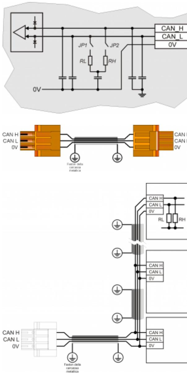
Esempio di collegamento CAN BUS.
