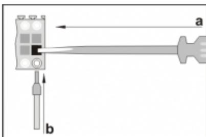
a) inserire il cacciavite senza ruotarlo
