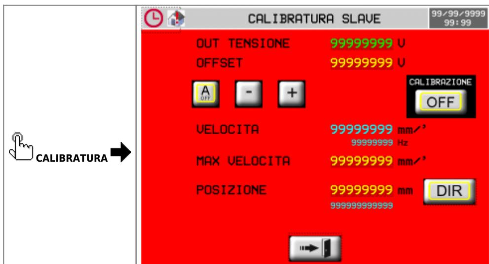
In questa pagina è possibile: - Verificare la corretta direzione di conteggio del Carrello - Trovare la velocità massima del Carrello - Regolare l'offset del motore del Carrello
