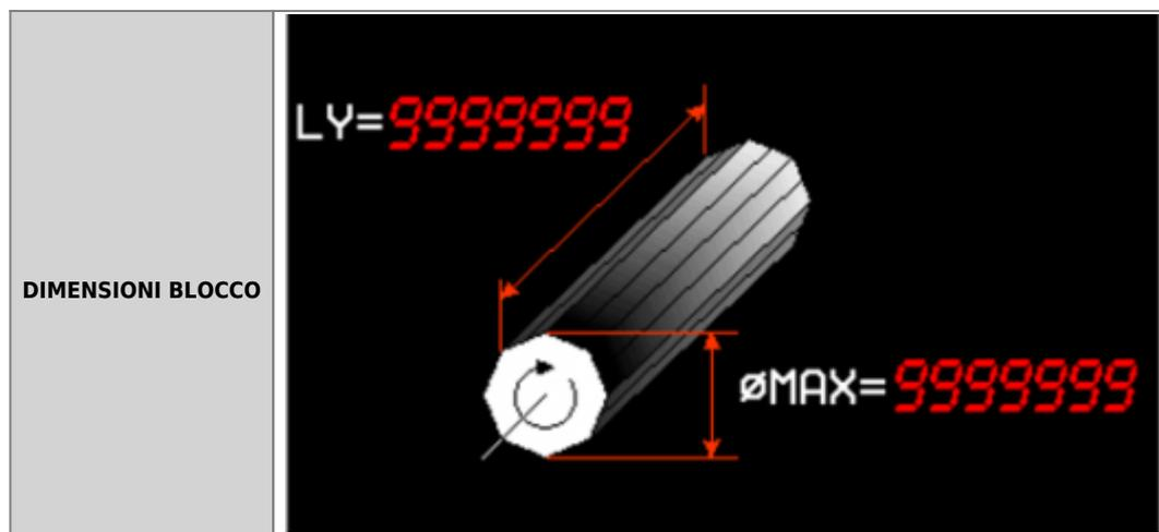
Il diametro massimo (Ø MAX) verrà utilizzato anche per calcolare la **profondità** dei tagli.
