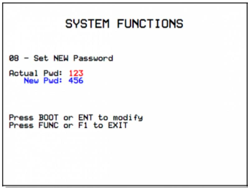
Al termine dell'introduzione della nuova password, viene visualizzato il messaggio "saving data..." che indica la memorizzazione del nuovo dato.
