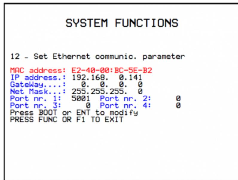
Vediamo in dettaglio: La porta impostata in "Port nr.1:" rappresenta un canale di comunicazione equivalente alla PROG PORT. La porta impostata in "Port nr.2:" rappresenta un canale equivalente alla USER PORT. Le porte 3 e 4 non sono attualmente utilizzate.
