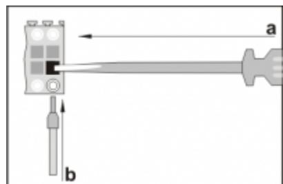
a) inserire il cacciavite senza ruotarlo
