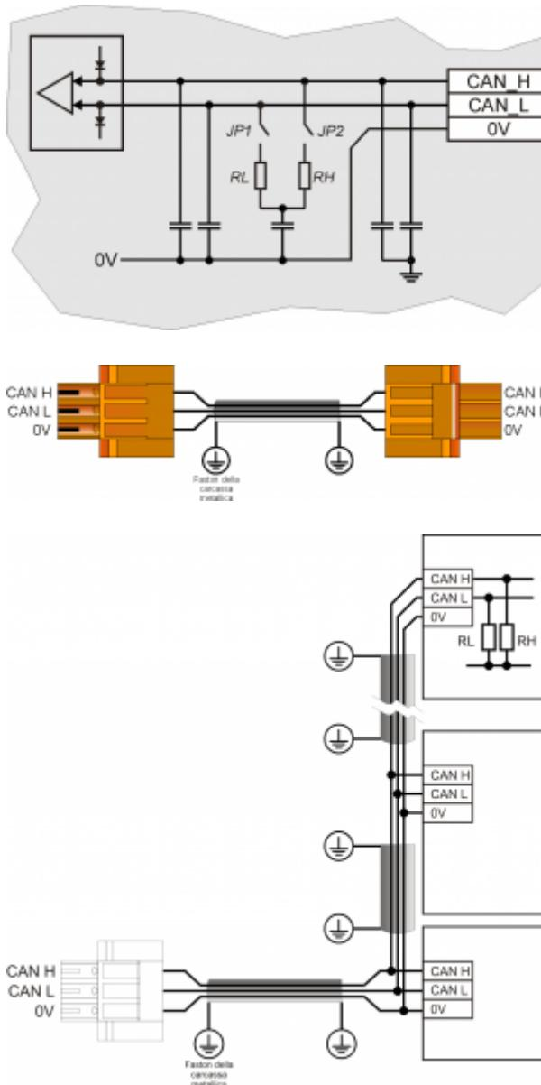
Esempio di collegamento CAN BUS.
