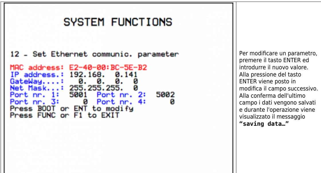
Per modificare un parametro, premere il tasto ENTER ed introdurre il nuovo valore. Alla pressione del tasto ENTER viene posto in modifica il campo successivo. Alla conferma dell'ultimo campo i dati vengono salvati e durante l'operazione viene visualizzato il messaggio "saving data..."
