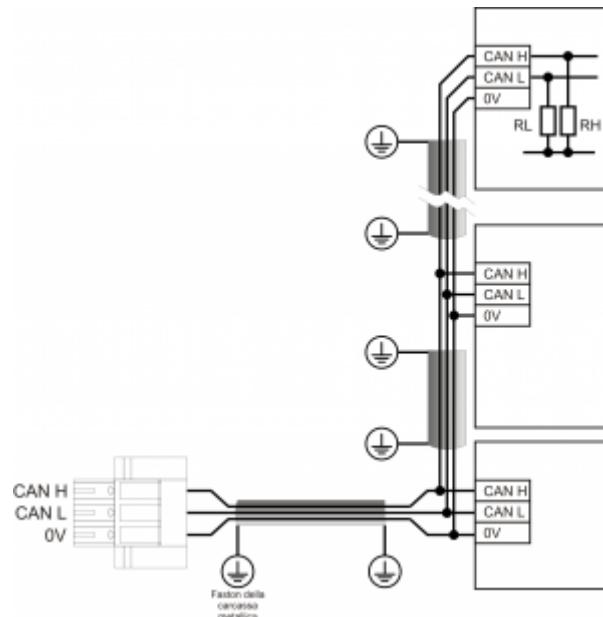
Esempio di collegamento CAN BUS.
