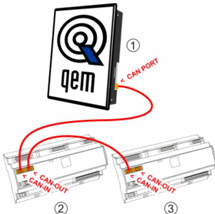
**! Sul primo (1) e sull'ultimo (3) dispositivo della catena, devono essere inserite le resistenze di terminazione.
