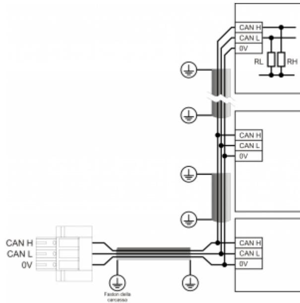
**! Attenzione: chiudere i DIP JP1 e JP2 ed inserire le resistenze di terminazione (RL, RH) sull'ultimo dispositivo della catena.**
