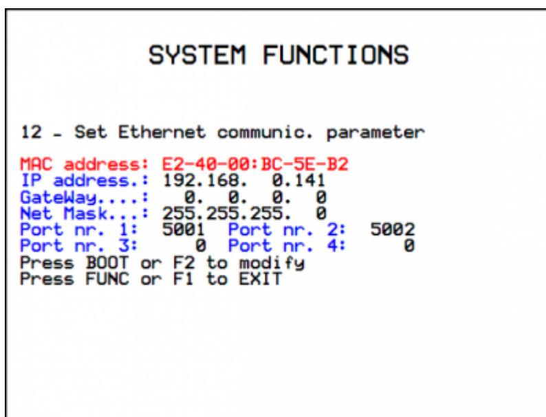
La porta impostata in "Port nr.1:" rappresenta un canale di comunicazione equivalente alla PROG PORT. La porta impostata in "Port nr.2:" rappresenta un canale equivalente alla USER PORT. Le porte 3 e 4 non sono attualmente utilizzate.
