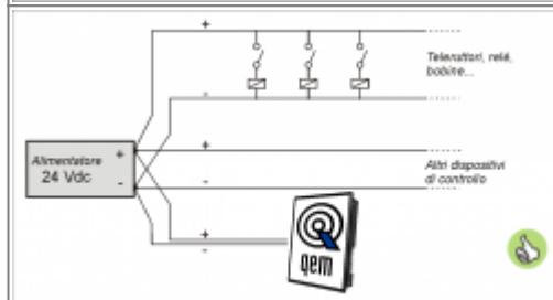
Nel caso di un unico alimentatore, usare due linee separate: una per il controllo e una per la potenza
