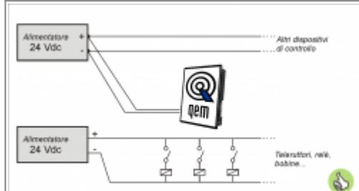
Usare due alimentatori separati: uno per la parte di controllo e uno per la parte di potenza
