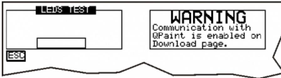
I led dei tasti funzione iniziano ad attivarsi in successione con frequenza variabile. Non viene eseguito il test dei leds di sistema ("Key", "Com", "State", "Error") perché il loro funzionamento non è programmabile e perché le loro indicazioni non sono essenziali al fine della funzionalità.
