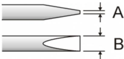
Cacciavite a lama piatta secondo DIN 5264. Coppia di serraggio:  $0,4 \pm 0,5$  Nm.
