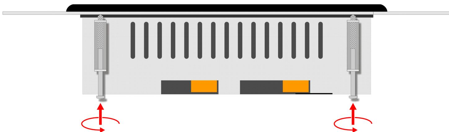
Fig. 3.9: Avvitare come indicato per fissare lo strumento.
