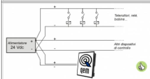
Nel caso di un unico alimentatore, usare due linee separate: una per il controllo e una per la potenza
