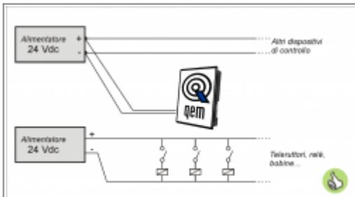
Usare due alimentatori separati: uno per la parte di controllo e uno per la parte di potenza
