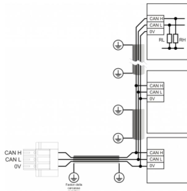
Esempio di collegamento CAN BUS.
