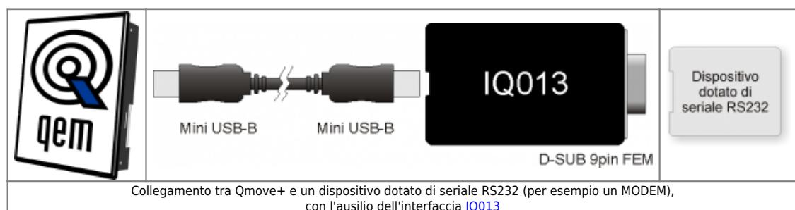
Collegamento tra Qmove+ e un dispositivo dotato di seriale RS232 (per esempio un MODEM), con l'ausilio dell'interfaccia [IQ013](#)
